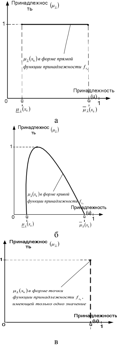
Рис. 2. Пример графического представления вертикального среза ИНМТ2 (а), НМТ2 (б) и НМТ1 (в), представленного как НМТ2
