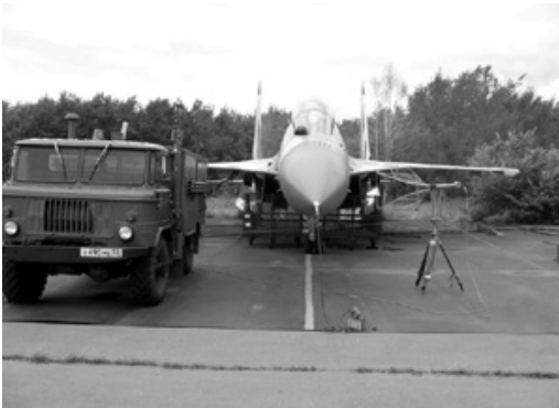
Рис. 5. Испытания БО в составе ЛА на ЭМС
