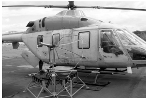
Рис. 3. Испытания БО в составе вертолета “Ансат” (HIRF в диапазоне МВ, ДМВ)
