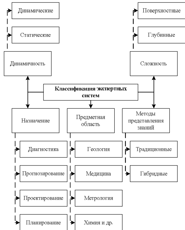
Рис. 2. Классификация экспертных систем
