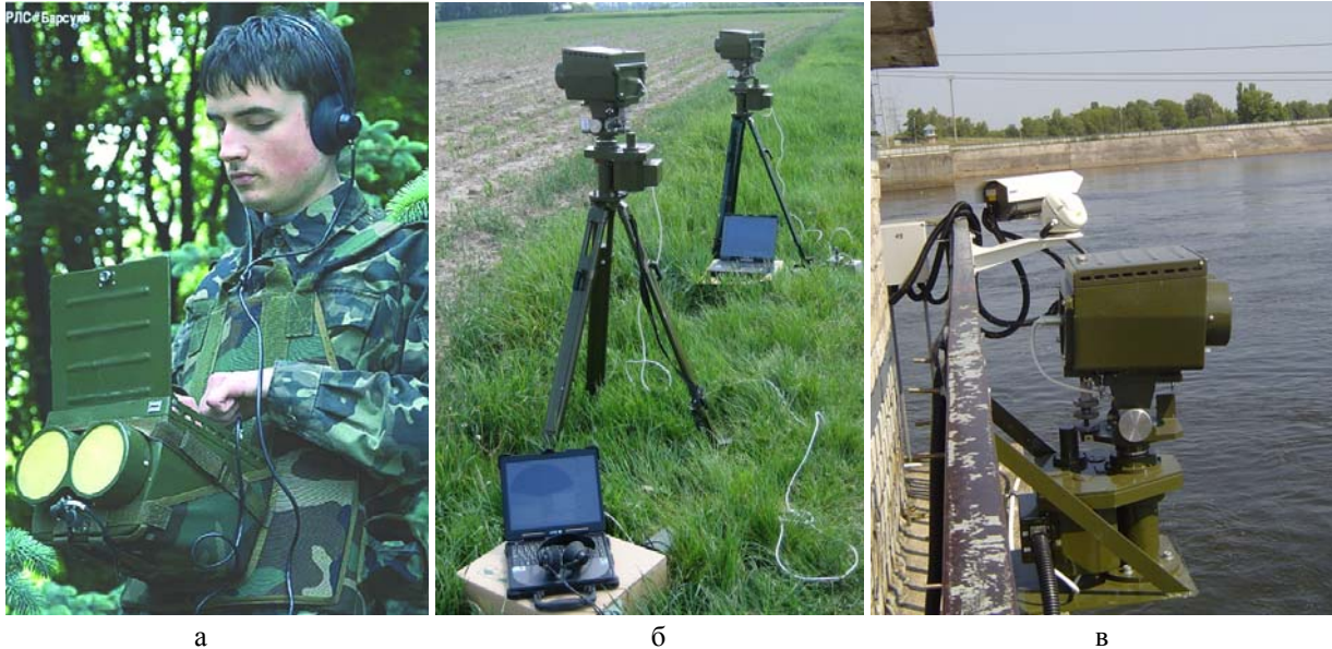
Рис. 5. Портативна РЛС «Барсук»: а – базовий переносний варіант; б – модифікація 112L1A "Барсук-А" на тринозі; в – "Барсук-А" на стаціонарній платформі
