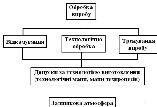
Рис. 6. Технологія обробки магнетрона
