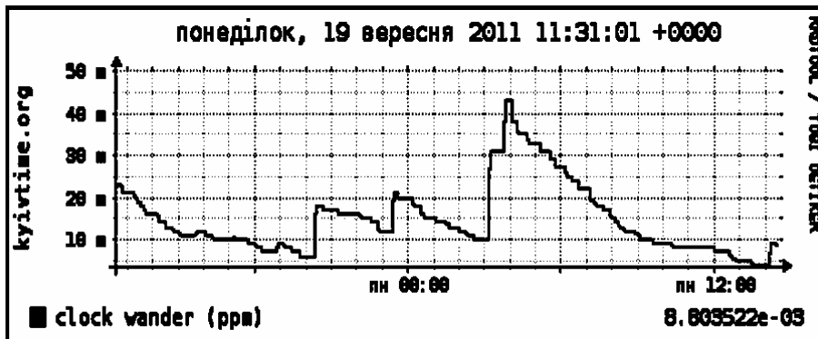
Рис. 11. Контроль сигналу часу від шкали часу водневого стандарту частоти Ч1-80 через мережу Інтернет на сервері kuivtime.org
