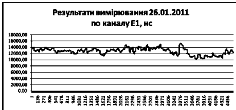
Рис. 10. Результати вимірювання 26.01.2011 по каналу E1. Постійна складова результатів вимірювання – 12772 нс, СКВ – 1031 нс
