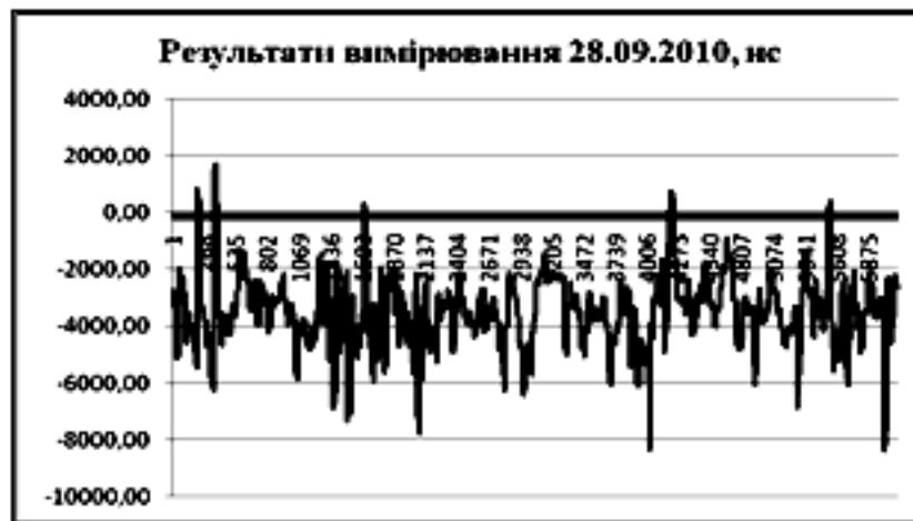
Рис. 4. Результати вимірювання під час тестування РТР комплексу на виділеній кільцевій лінії Укрметртиместандарт по м. Києву. Довжина лінії — 32 км. Вимірювання проводяться 30 раз за одну хвилину кожні 5 хвилин. Постійна складова результатів вимірювання протягом 18 годин – мінус 3,5 мкс; СКВ – 1,3 мкс.
