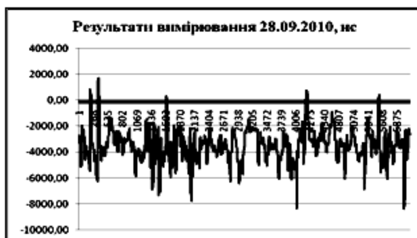
Рис. 4. Результати вимірювання під час тестування РТР комплексу на виділеній кільцевій лінії Укрметртиместандарту по м. Києву. Довжина лінії — 32 км. Вимірювання проводяться 30 раз за одну хвилину кожні 5 хвилин. Постійна складова результатів вимірювання протягом 18 годин – мінус 3,5 мкс; СКВ – 1,3 мкс.
