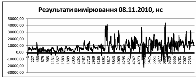
Рис. 6. Результати вимірювання 08.11.2010 під час тестування РТР-комплексу на виділеній кільцевій лінії на трасі Київ – Харків – Київ зі зміною швидкостей передачі. Довжина траси – 800 км
