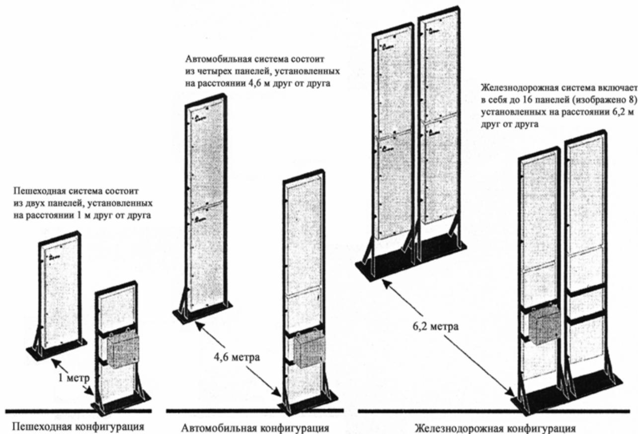
Рис. 1. Спектрометрический порталный монитор
