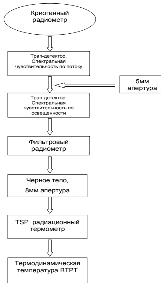
Рис. 1. Цикл измерения термодинамической температуры ВТРТ
