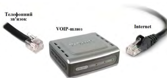
Рис. 1. Принципова схема організації телефонного зв'язку та VOIP-шлюзу
