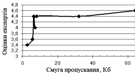
Рис. 2. Залежність якості зв'язку від ширини каналу пропускання
