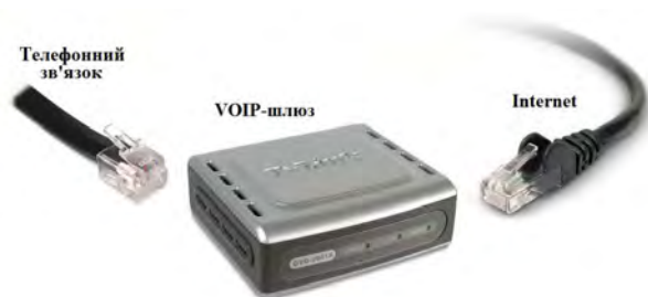
Рис. 1. Принципова схема організації телефонного зв'язку та VOIP-шлюзу
