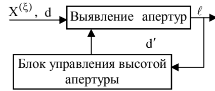
Рис. 2. Структурная схема выявления апертур с управляемым выбором ее высоты
