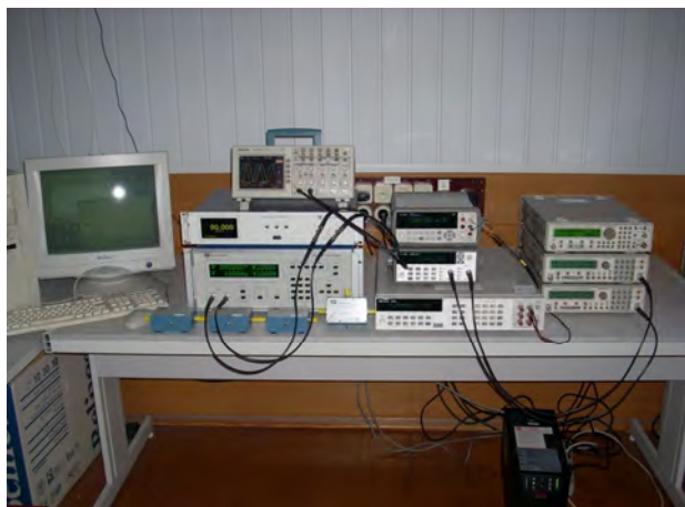
Рис. 1. Державний первинний еталон одиниці кута зсуву фаз між двома напругами
