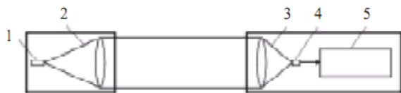
Рис. 3. Функціональна схема лазерної системи виміру (контролю) габаритів об'єктів (порушників):
