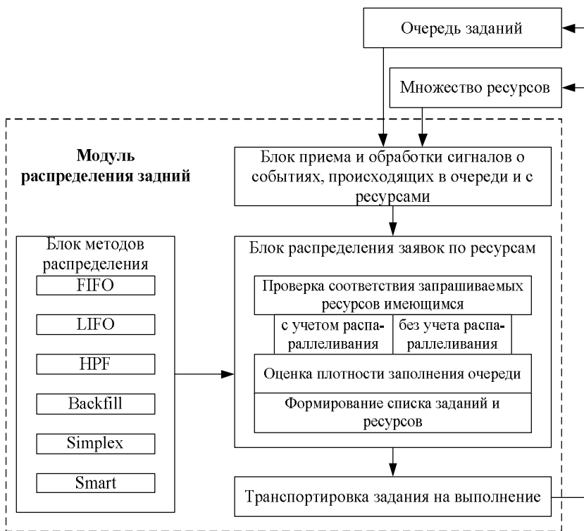
Рис. 3. Структура модуля распределения потока заданий на вычислительные ресурсы
