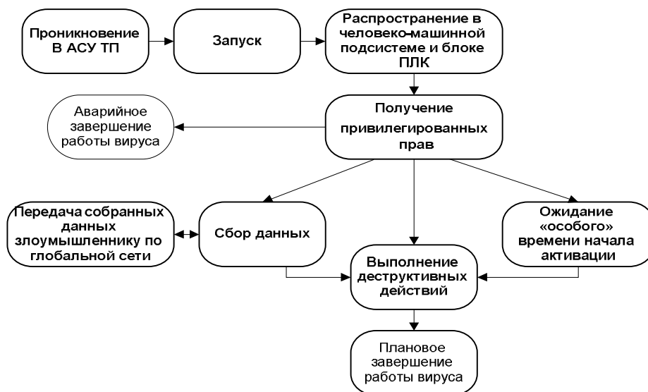
Рис. 2. Схема узагальненого алгоритму можливого поведіння злоумисленого програмного забезпечення (комп'ютерного вірусу) при атаці ОС QNX АСУ ТП
