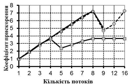
Рис. 3. Залежність коефіцієнта прискорення від кількості виділених потоків при розв'язанні рівняння Пуассона (1) в просторовій області при M=500 та N_{it}=500 : \Delta – Dual Intel Xeon E5345; \circ – Intel Core I7-2600k (HT on); \square – Intel Core I7-2600k (HT off)
