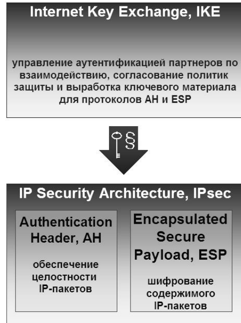
Рис. 4. Основные компоненты протокола сетевой безопасности IPsec
