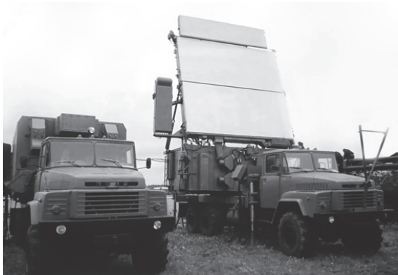
Рис. 2. Типова радіолокаційна станція з пасивною ФАР
