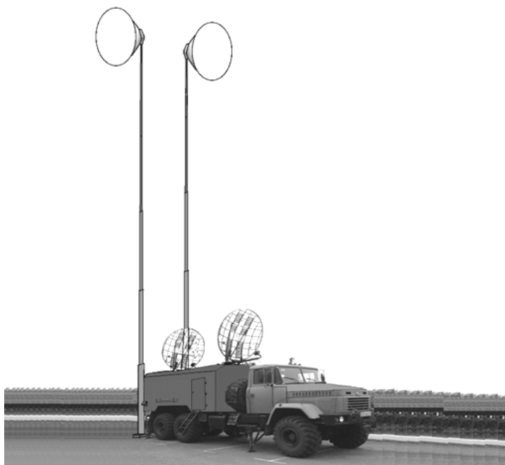
Рис. 2. Конструктив цифровой тропосферно-радиорелейной станции на базе тропосферных станций (Р-412, Р-417, Р-423-І)
