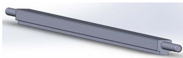
Рис. 2. Трехмерная модель стяжной шпильки статора
