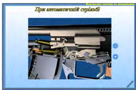
Рис. 8. Робота частин і механізмів автомата
