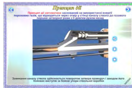
Рис. 3. Принцип дії автоматики
