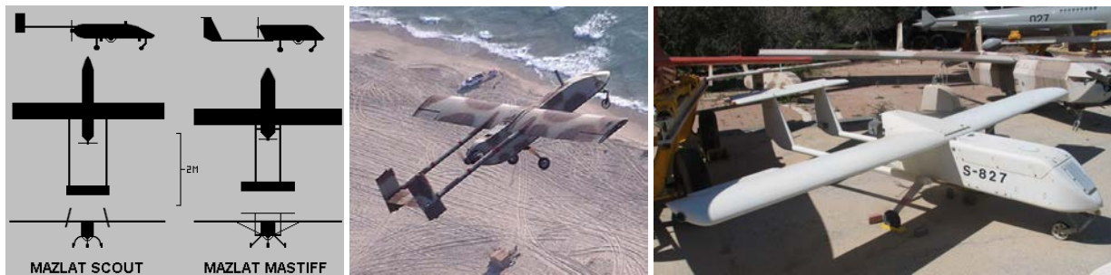
Рис. 11. Схема та фотографія БПЛА “Скаут” і “Мастіфф”
