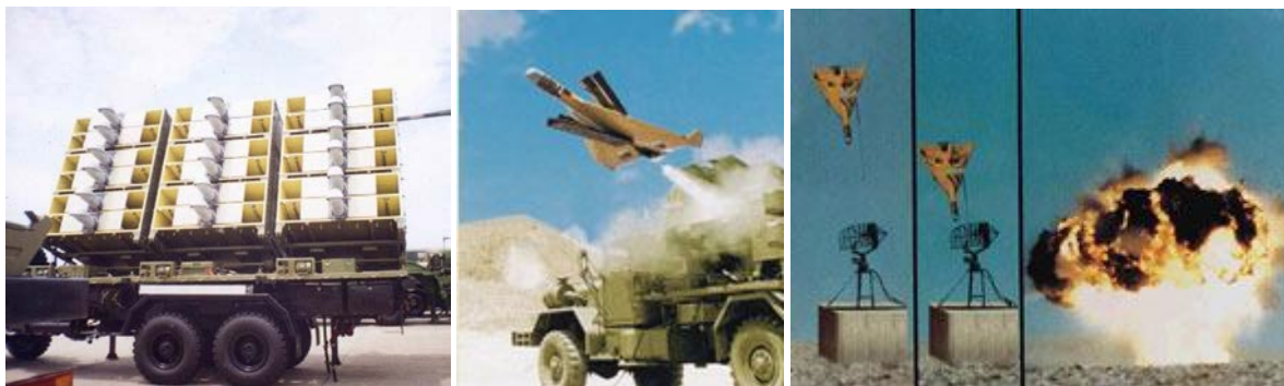
Рис. 10. Запуск БПЛА Нагру (“Шион”) і поразка ним цілі-імітатора РЛС
