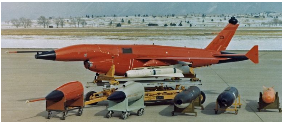
Рис. 2. Багатоцільовий БПЛА BGM-34C з різними модулями.
